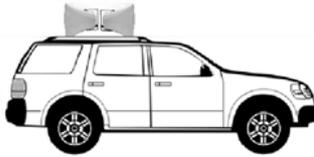
Em publicidade móvel de ruas usando carros, pode-se usar duas cornetas falantes modelo CF006880 de 80W com ligação em paralelo, colocadas uma direcionada para frete e outra para trás. Não há necessidade de coloca-las nas laterais.
