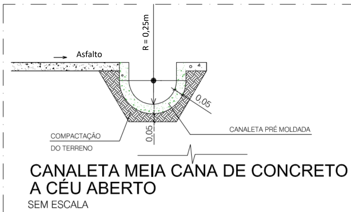
Figura 4: Detalhamento da instalação da canaleta meia cana de concreto.
